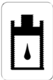
Место добавления гидравлического масла
