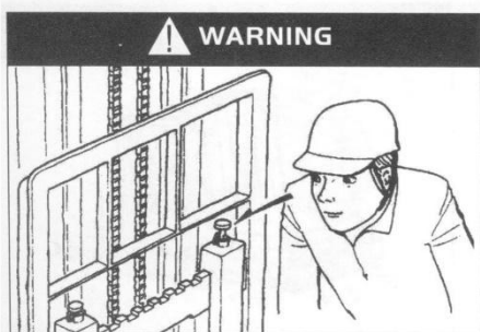
Проверьте положение штифта на раме вил
